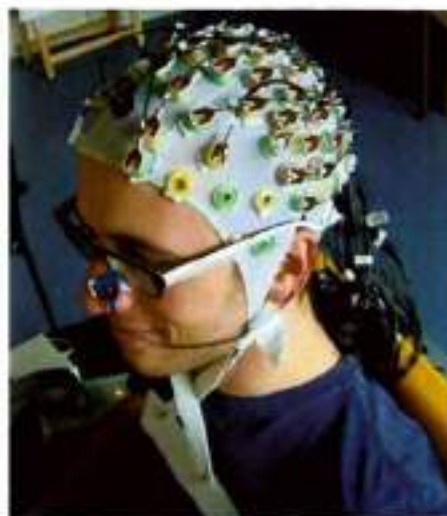
Figura E.2 Touca com 62 eletrodos posicionados sobre o couro cabeludo do autor para um experimento BCI.
