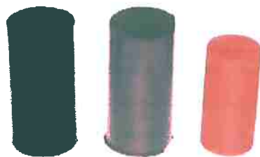
Figura 6.1. – Corpos de prova da esquerda para a direita: NR, FKM, PU.
