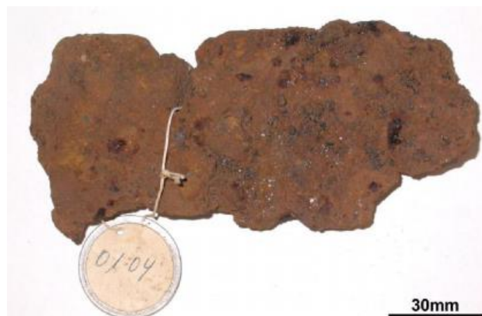
Figura 18: Amostra 106 Sardinha, aspecto visual. Camada de óxido quebradiça na superfície. Aumento de menos de dez vezes [21].
