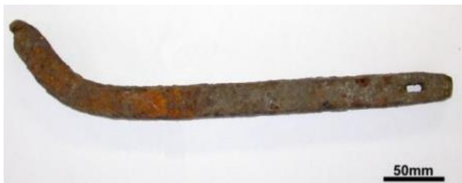
Figura 15: Amostra 99. Há uma camada de óxido visível, quebradiça, na superfície. Foto tirada com máquina digital com redução [21].
