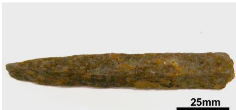
Figura 21: Amostra 111, com camada quebradiça de óxido em sua superfície [21].
