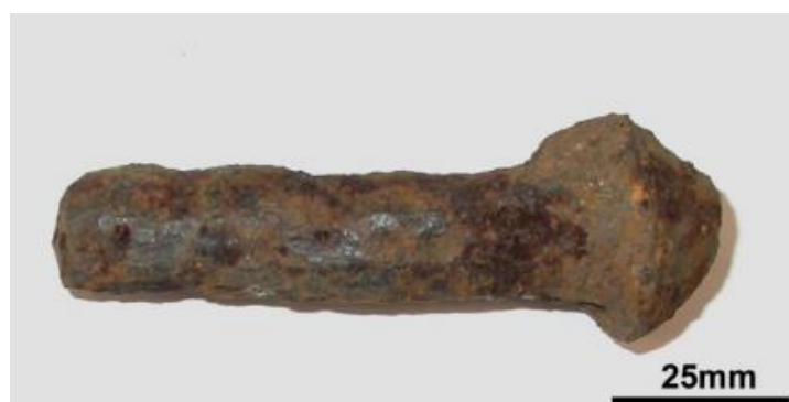
Figura 19: Aspecto visual da amostra 107. Camada quebradiça de óxido na superfície. Aumento de menos de dez vezes [21].
