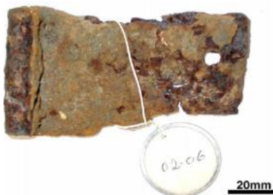
Figura 16: Visual da amostra 84. Camada de óxido é novamente visível na superfície. Foto tirada com máquina digital com aumento menor que dez vezes [21].
