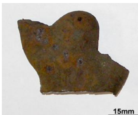
Figura 17: Amostra 73, aspecto visual. Gusa sueco. Também apresenta camada quebradiça de óxido na superfície. Aumento de menos de 10 vezes [21].
