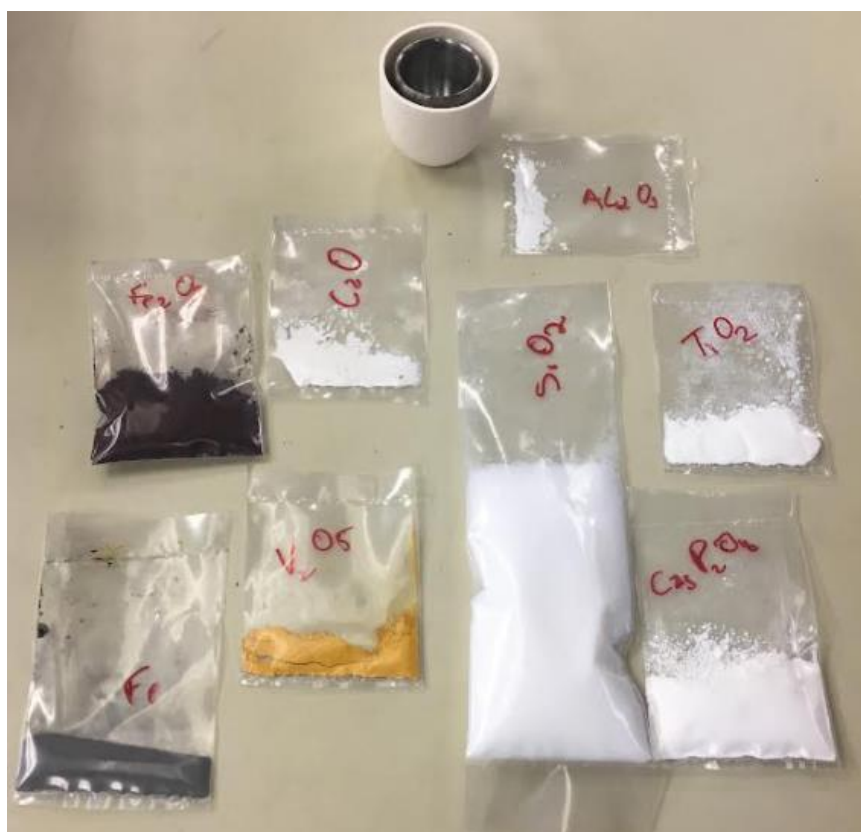
Figura 29: Amostras de materiais utilizados na síntese das escórias, e o cadinho utilizado. O cadinho é de ferro, e foi protegido externamente por um segundo cadinho de alumina. Os compostos utilizados foram \text{Fe}_2\text{O}_3 , \text{F}_2 , \text{V}_2\text{O}_5 , \text{CaO} , \text{SiO}_2 , \text{Al}_2\text{O}_3 , \text{TiO}_2 e \text{Ca}_3\text{P}_2\text{O}_8 .
