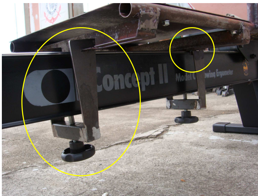
Figura 32: Detalhe das guias e dos grampos na fixação da cadeira junto ao remo-ergômetro.
