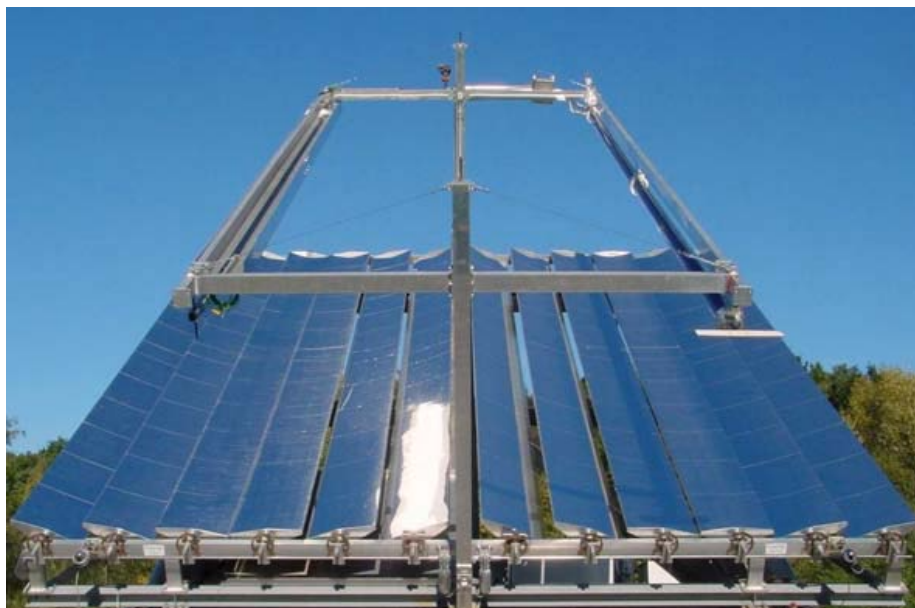
Figura 3.7 Coletor concentrador Fresnel, construído por Heinrich (IEA, 2005).
