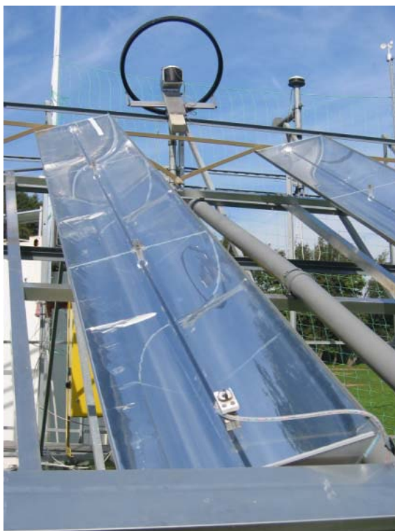
Figura 3.1 Coletor concentrador parabólico linear PARASOL (IEA, 2005).
