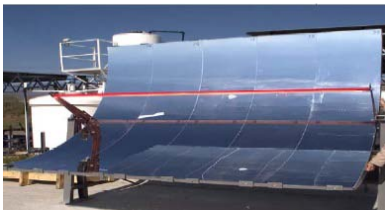
Figura 3.6 Coletor concentrador parabólico FASOL (IEA, 2005).
