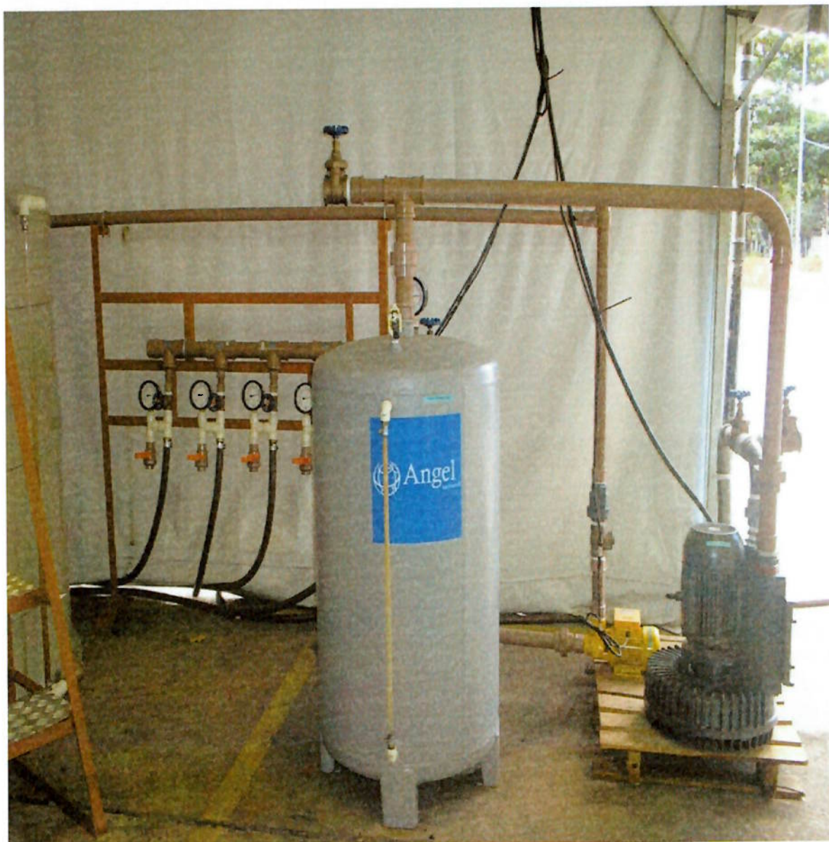
Figura 12: Ilustração do cilindro de vácuo, compressor radial, bomba de transferência e manifold de poços de injeção de um sistema EMF convencional. Fonte: projeto ANGEL.
