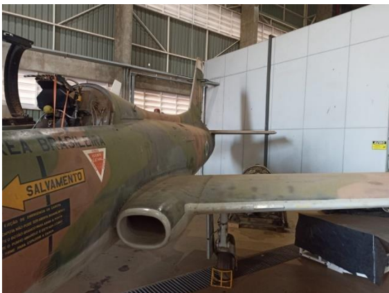
Figura 15. Detalhe união asa-fuselagem AT-26 Xavante
