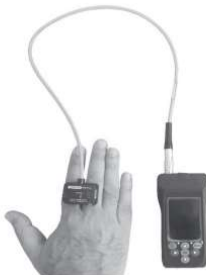
Figura 16 - Medidor de vibração com acelerômetro adaptado a mão
