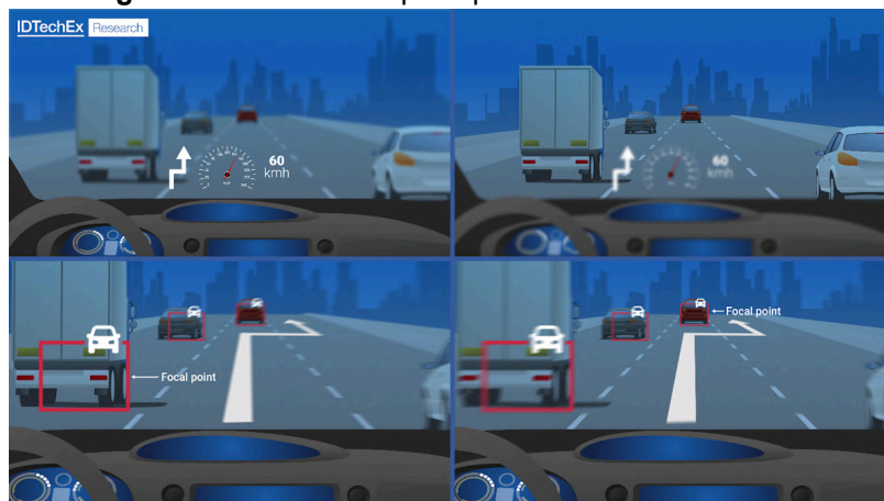
Figura 57 - Foco/desfoco e profundidade do AR-HUD.
