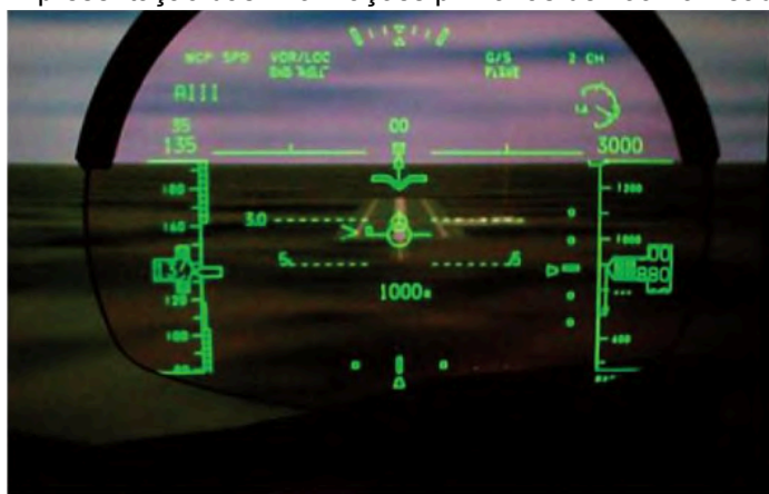
Figura 54 - Apresentação das informações primárias de voo no Head-up Display.
