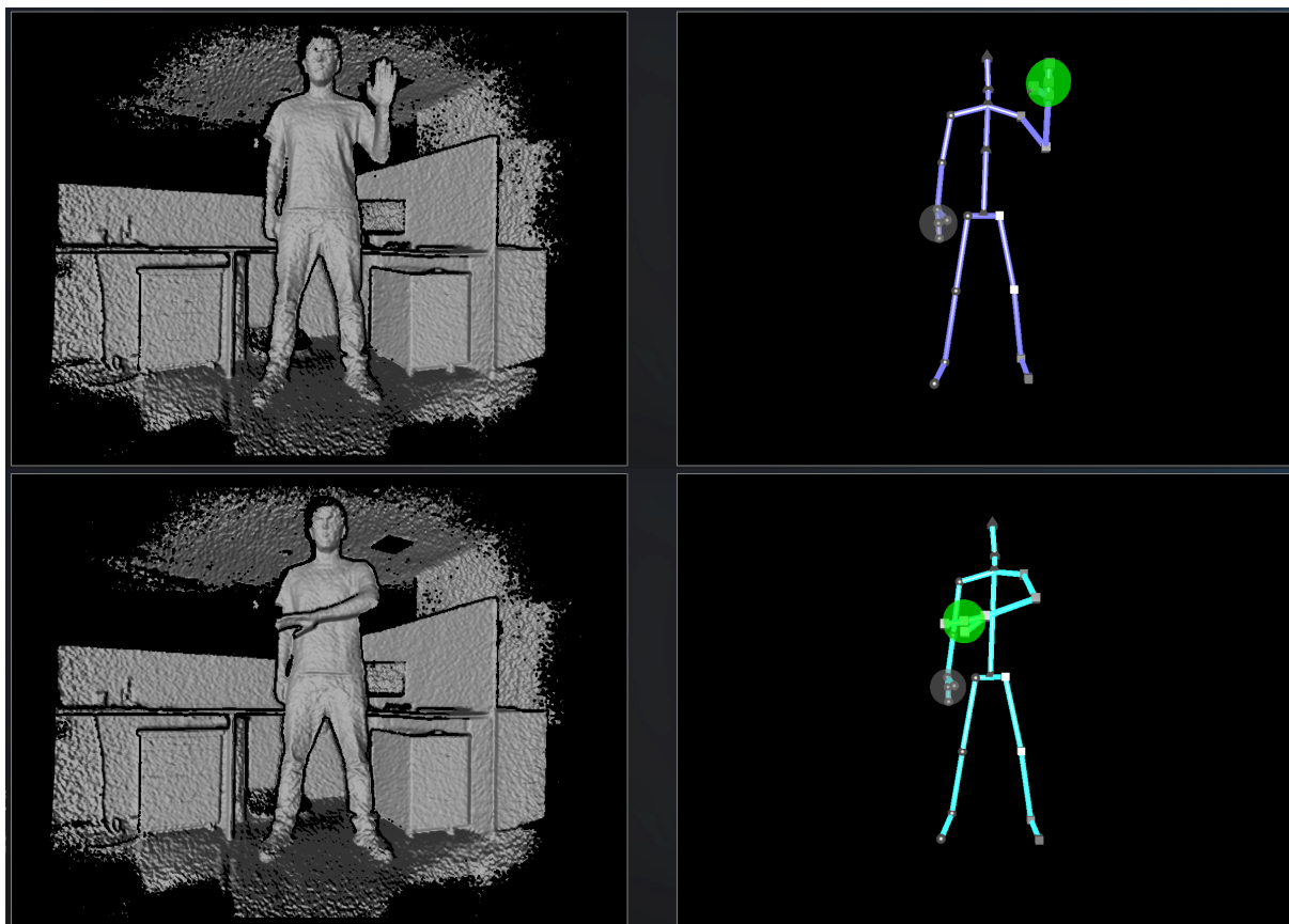
Figura 18 – Dois momentos do movimento realizado para testar a captura de dados pelo sensor e seu registro na estrutura de dados presente na SDK .
