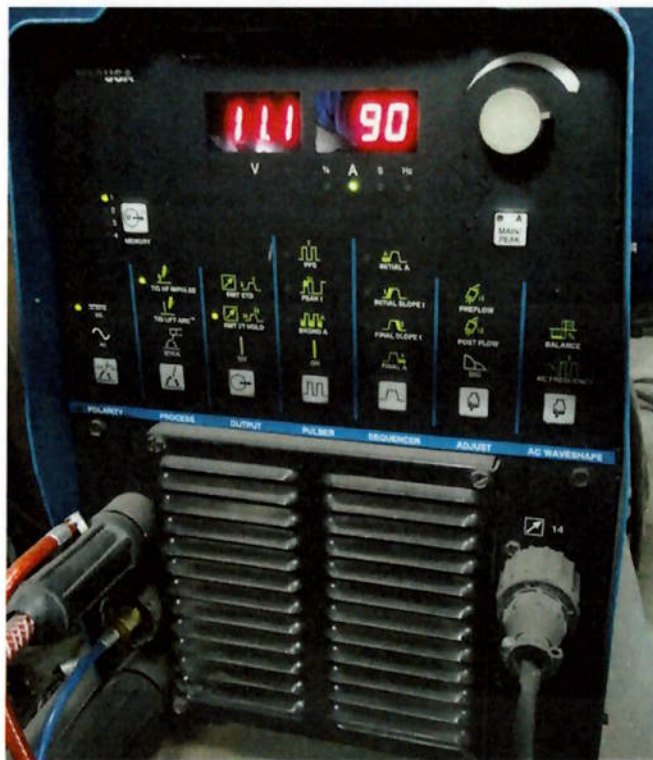
Figura 23: Vista frontal da Máquina de Soldagem GTAW Dynasty 300 DX
