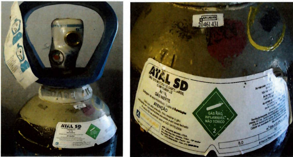
Figura 18: Cilindro de Ar + N 2 utilizado para estabilidade do arco elétrico e proteção da poça de fusão pelo processo GTAW.
