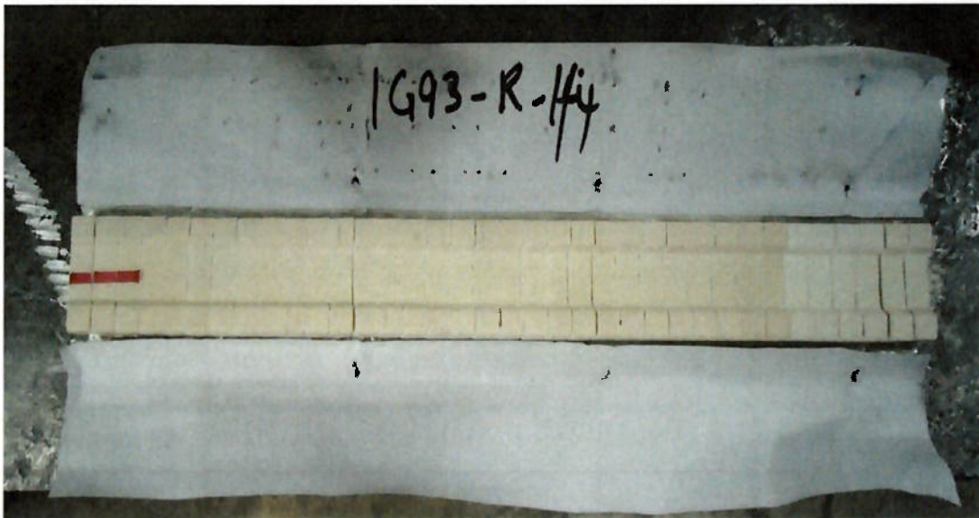
Figura 19: Backing cerâmico utilizado para proteção da raiz.
