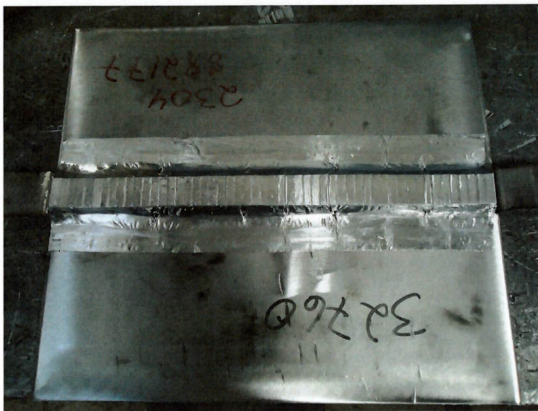
Figura 20: Preparação do corpo de prova com backing cerâmico para proteção da raiz.
