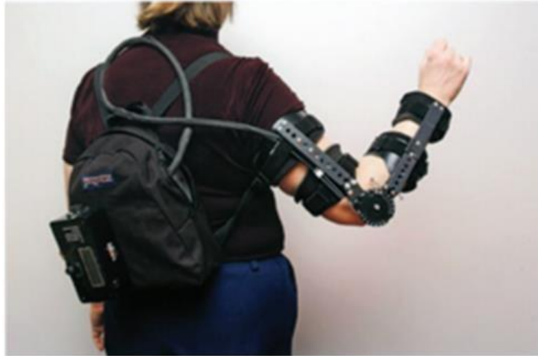
Figura 4.13: Órtese motorizada com algoritmos de controle.
