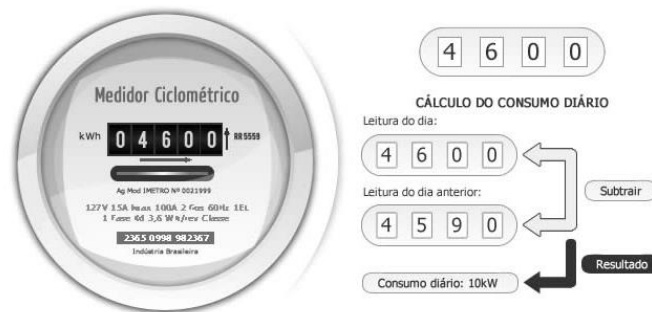
Figura 5: Método de aferição do consumo em medidores ciclométricos
