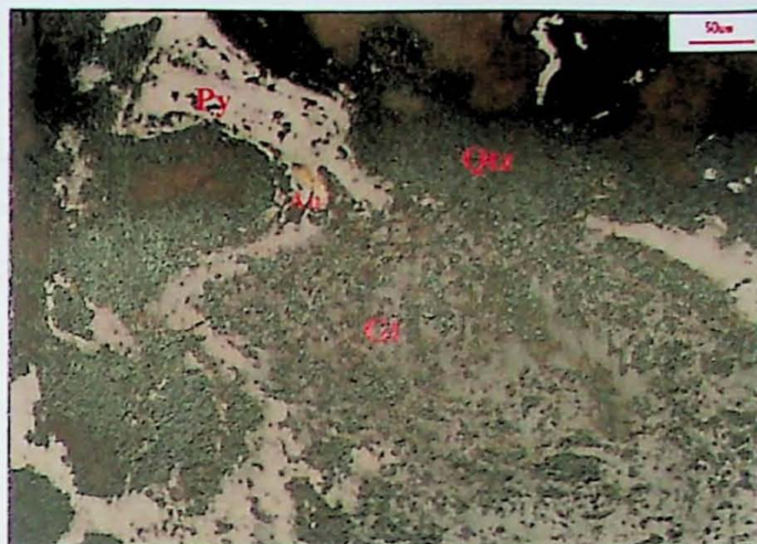
Figura 12 – seção polida de veios de quartzo (Qtz) da empresa LARA Exploration Ltd. Apresentando pirita (Py) e ouro nativo (Au) em goethita (Gt) da mostra 850872A. 200X.
