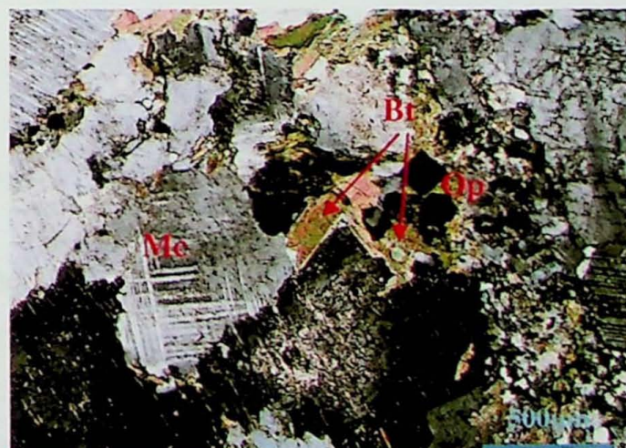
Figura 28 – Lâmina BJ-01-B, pol. superior, 5X. Contraste entre o tamanho dos minerais, possível falha que cominuiu os cristais à direita. Microclínio com geminação em grade e biotitas associadas a opacos idiomórficos. Escala: lado menor = 2 mm.
