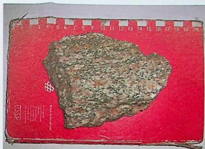
Figura 16 – Rocha de composição granítica que representa a localidade Grota do Cozinheiro. Reparar no grau de milonitização desta rocha, pelos cristais sigmoidais de feldspato potássico.
