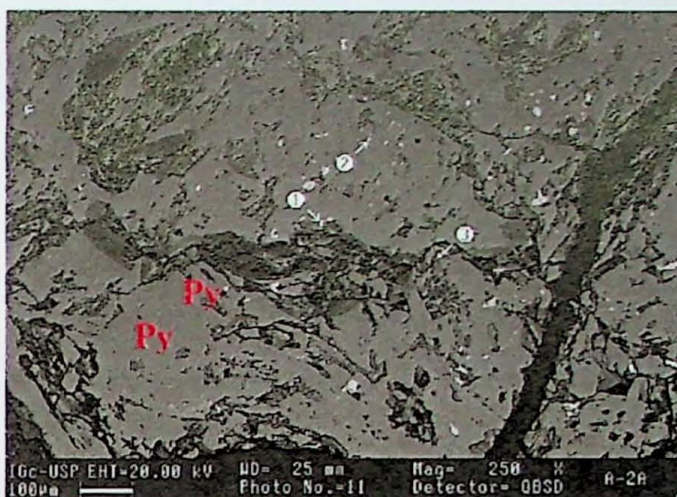
Figura 22 – Fotografia feita no MEV de parte da seção A-2A. Os números representados na foto correspondem à inclusões de calcopirita, na pirita. A porção inferior do cristal (pirita) parece ter sofrido um dobramento.
