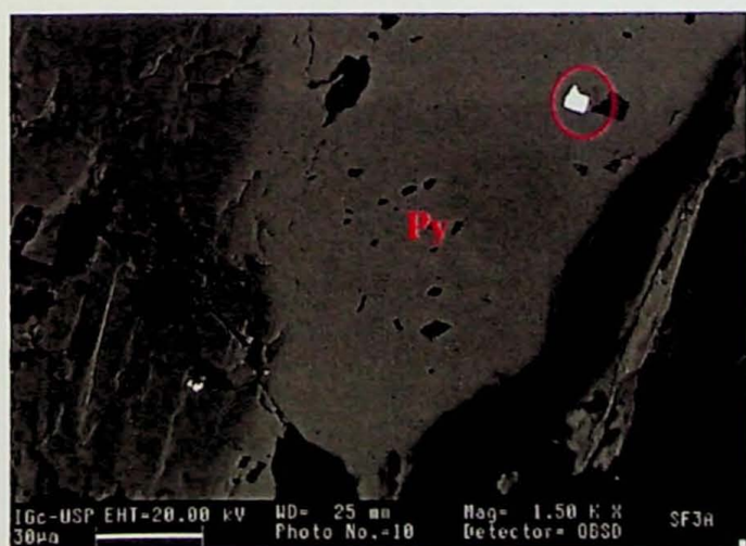
Figura 13 – Fotografia feita no MEV de parte da seção SF-03A. Destaque para inclusão idiomórfica (circulada acima), que corresponde a um sulfeto de Bi, Cu e Ag. E o ponto esbranquiçado menor à esquerda inferior, que corresponde a um sulfeto de Te e Bi.
