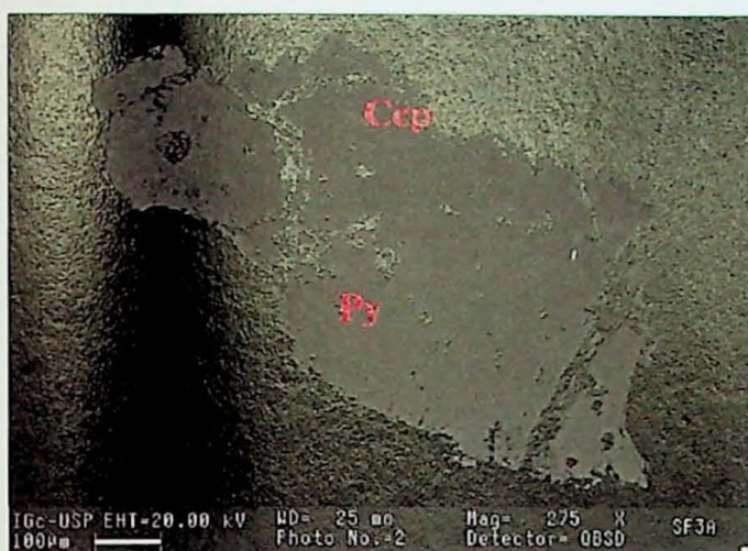
Figura 15 – Fotografia feita no MEV de parte da seção SF-03A. Cristal subidiomórfico de pirita, apresentando calcopirita (esquerda superior) e um sulfeto rico em Te e Bi (direita superior).
