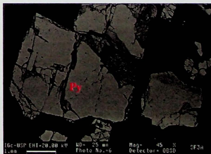
Figura 14 – Fotografia feita no MEV de parte da seção SF-03A. Notar como as inclusões na pirita (Py) são mais raras (ausência de pontos claros) nos grãos idiomórficos desta seção.
