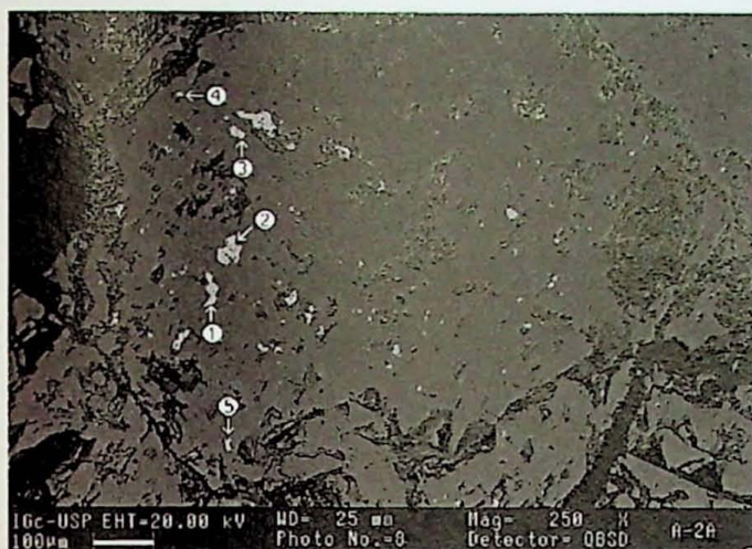
Figura 21 – Fotografia feita no MEV de parte da seção A-2A, mostrando minerais com maior densidade. Os pontos indicados na foto correspondem a: 1- cubanita ( \text{CuFe}_2\text{S}_3 ), 2-calcopirita, 3-calcopirita, 4- galena, 5- calcopirita.
