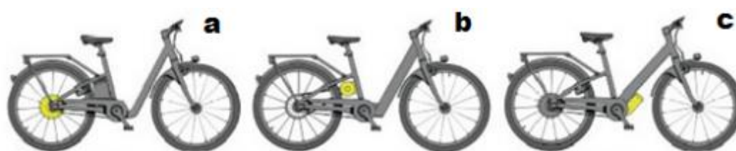
Figura 9 – Possíveis posições do motor em uma bicicleta elétrica: a) Cubo de roda; b) Movimento central; c) Catraca
