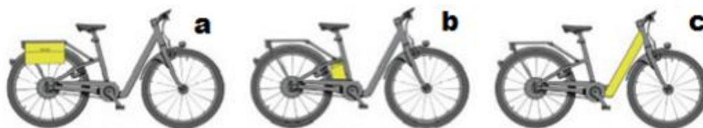
Figura 10 – Possíveis posições da bateria em uma e-bike: a) Rack traseiro; b) Quadro; c) Tubo inferior
