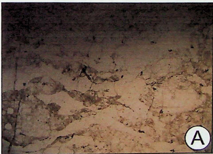
Fotomicrografia 4: Amostra TC-09A - Textura geral do granito leucocrático protomilonítico. Rocha de granulação grossa e textura essencialmente granoblástica, com porfiroclastos de feldspato envolvidos por ribbons de quartzo recristalizados. Lado maior da fotomicrografia = 12 mm.
