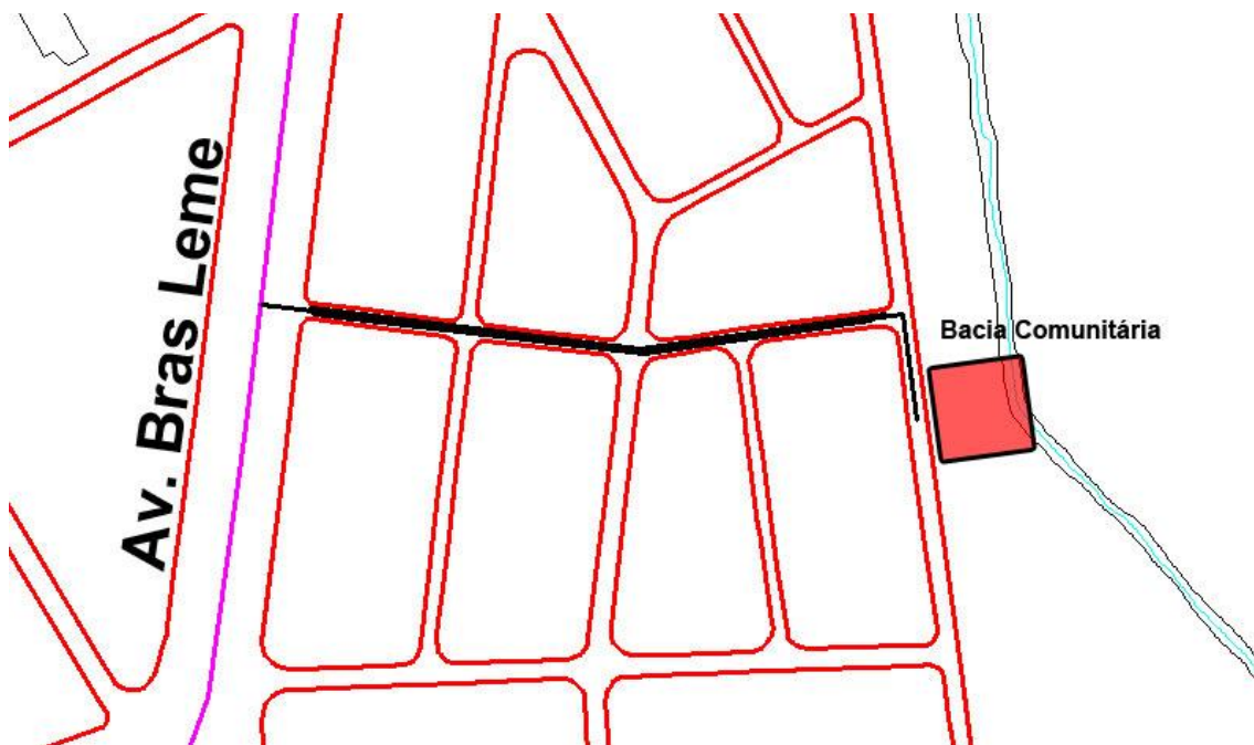
Figura 22 - Traçado da tubulação de captação
