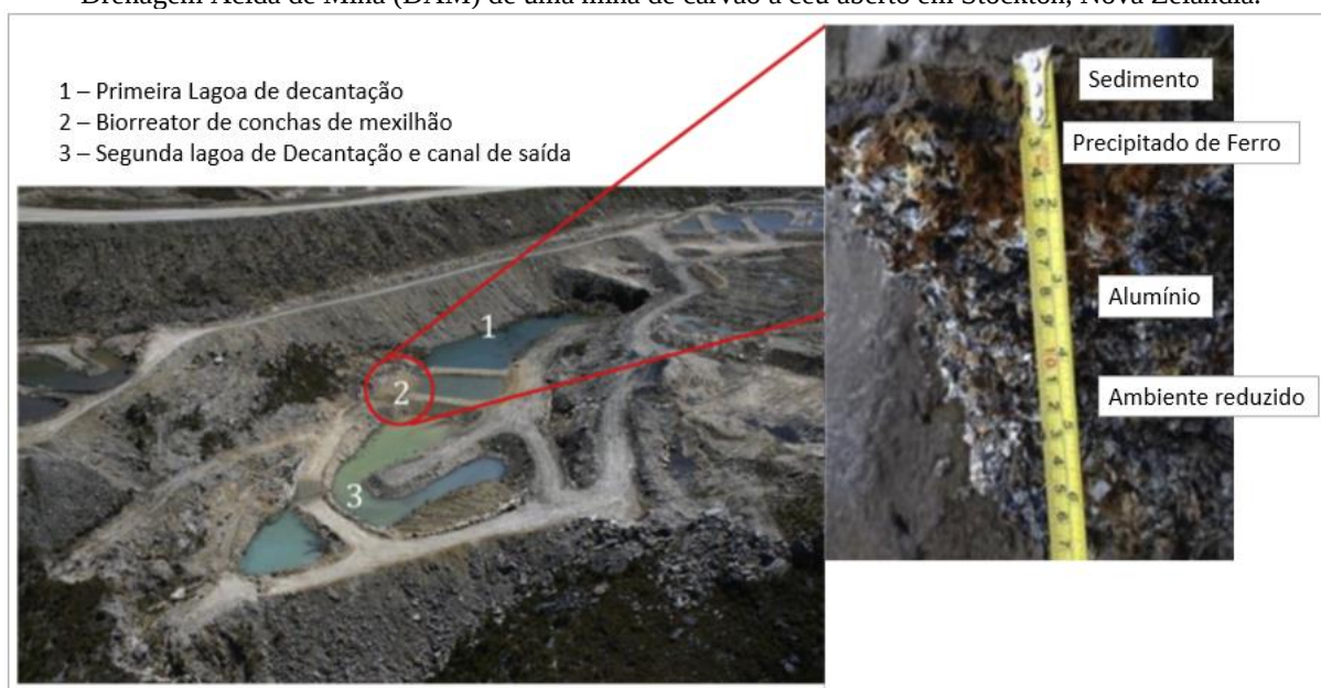
Figura 6: Imagem do Biorreator de conchas de mexilhão em funcionamento para tratamento passivo da Drenagem Ácida de Mina (DAM) de uma mina de carvão a céu aberto em Stockton, Nova Zelândia.
