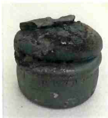
Figura 29 – Fração metálica resultante do ensaio com escória e proporção 1:12
