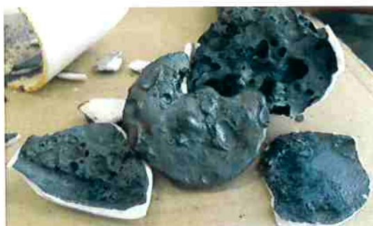
Figura 26 - Resultado do ensaio sem escória e proporção 1:2 após a retirada do cadinho
