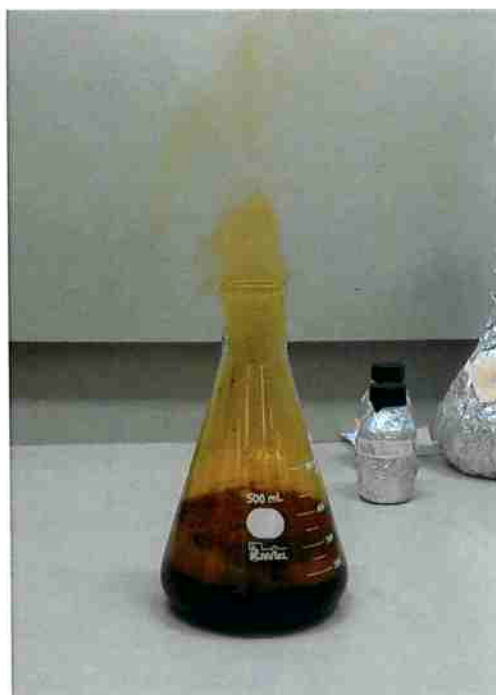
Figura 11 - Digestão em água régia após 3 minutos do início do ensaio
