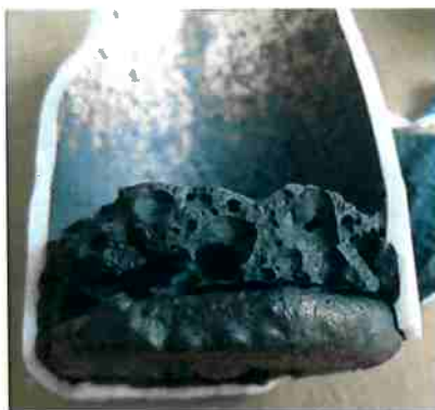
Figura 25 - Resultado do ensaio sem escória e proporção 1:2
