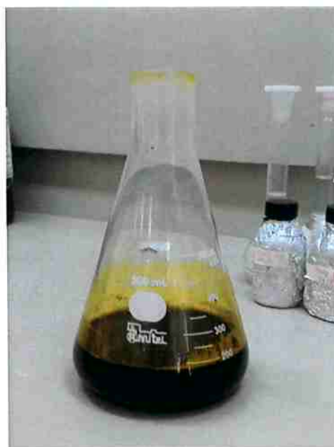
Figura 12 - Digestão em água régia após 24 horas do início do ensaio
