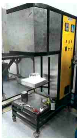
Figura 8 - Forno elétrico utilizado na fusão do cavaco
