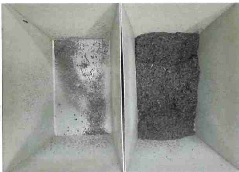
Figura 21 - Resultado final da separação magnética
