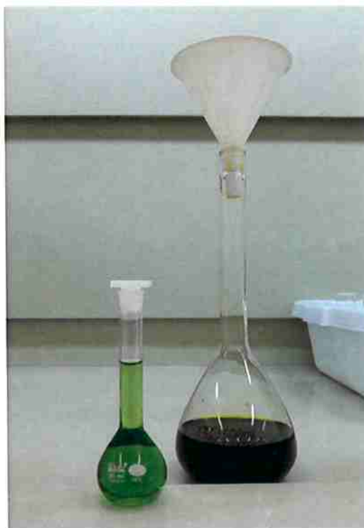
Figura 14 - Solução após digestão em água régia diluída de 1:10 e 1:2 (na ordem)
