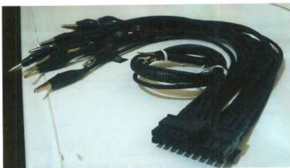
Figura 42 - Cabo do conjunto de 16 eletrodos que se fixam à estrutura alva.
