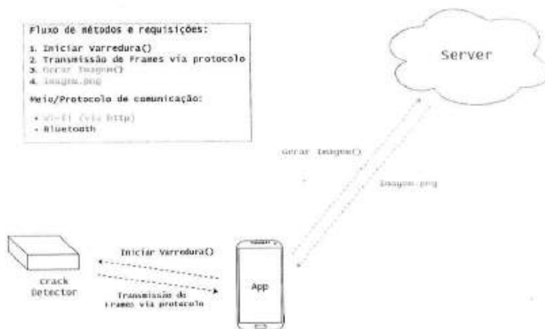
Figura 36 – Arquitetura de sistema de integração do detector de fissura com app mobile e processamento do algoritmo EIT em nuvem. [Fonte: Autor, 2015]
