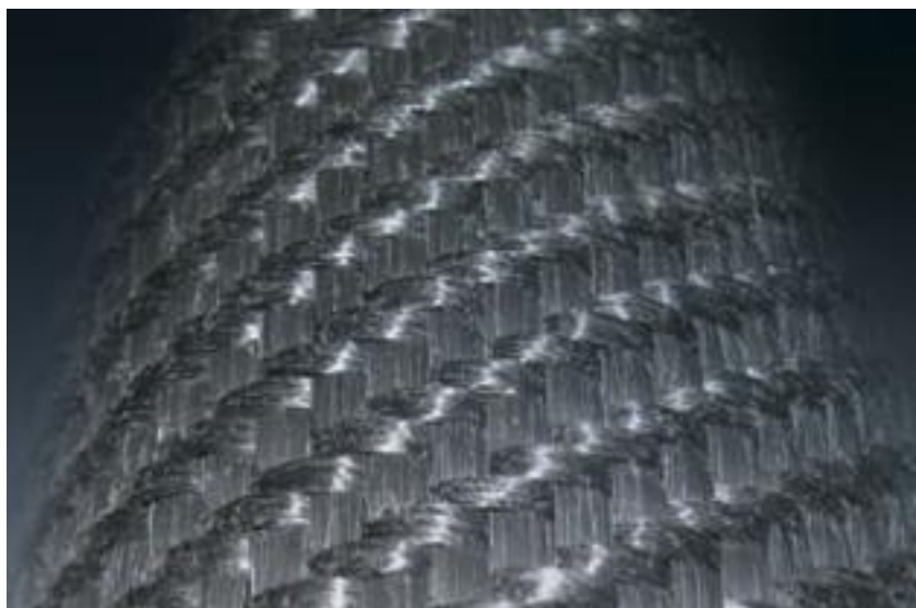
Figura 26 - Imagem ilustrativa do tecido geotêxtil do geotube e seu tipo de costura ondulada (“woven textile”)
