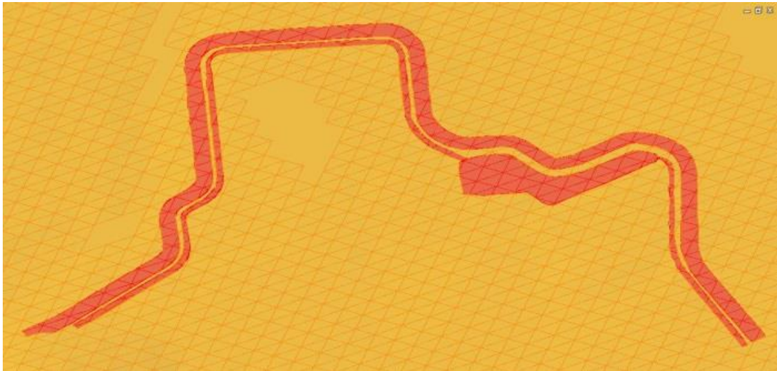
Figura 61 - Modelagem 3D das escavações obrigatórias para levantamento de volumes.
