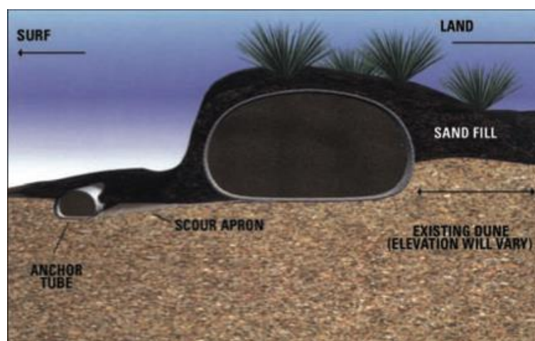
Figura 18 - Esquema de seção em corte de uma duna de areia erguida com aplicação do geotube. Fonte: Site da fabricante Tencate ( http://www.geotube.com , acesso em 20/06/13)
