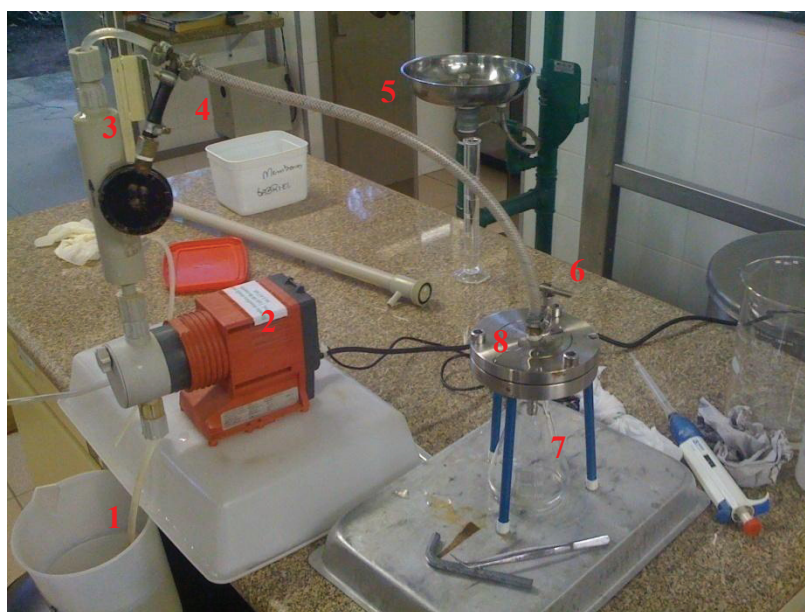
Figura 4-6 - Foto da unidade de ultrafiltração utilizado com seus elementos respectivamente numerados
