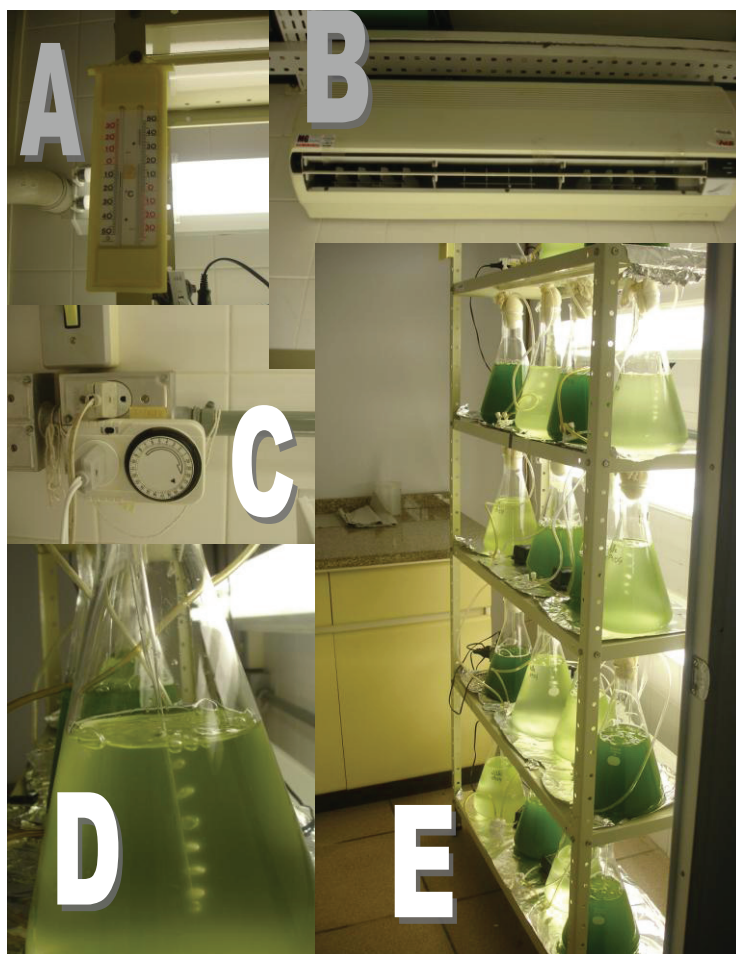
Figura 4-2 - A) Termômetro para verificação da temperatura; B) Climatizador de Ar; C) Temporizador para controle da luminosidade; D) Insuflamento de Ar; E) Sala de Cultivo
