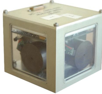
Figura 1 - Sistema de controle com rodas de reação em três eixos disponível comercialmente no site CubeSatShop.com (ISIS, 2006)
