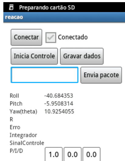
Figura 14 - Interface visual do aplicativo Android usado para controlar o sistema. O usuário pode usar o botão no topo da tela para iniciar a conexão Bluetooth com o módulo. Depois disso, é possível enviar comandos manualmente usando um campo numérico editável, que aceita valores de -255 a 255, representando a faixa de valores de tensão média que podem ser aplicados ao motor usando PWM. Um botão permite que se inicie o modo de gravação de dados, no qual os valores da variável yaw são registrados conforme atualizações são recebidas do sensor, e posteriormente gravados em um arquivo. Os ângulos de roll , pitch e yaw também são calculados e exibidos. Por último, o usuário pode realizar o controle automático na variável \psi ( yaw ) por meio de um controlador tipo PID, podendo inclusive escolher os parâmetros.
