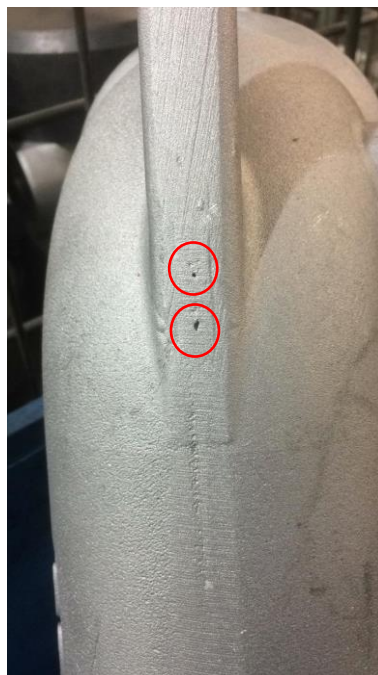
Figura 32 – Presença de rechupe próximo ao ataque inferior da peça. (Fonte: fundição Vldos)
