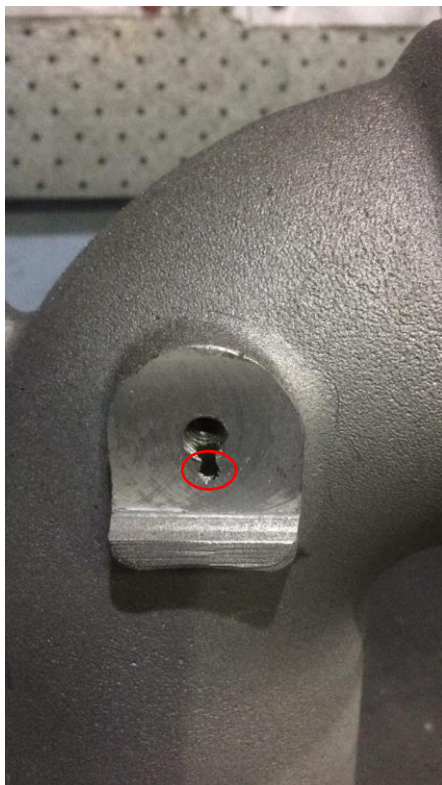
Figura 36 – Porosidade por contração na região da peça já usinada na interface peça/massalote lateral. (Fonte: fundição Vlado)
