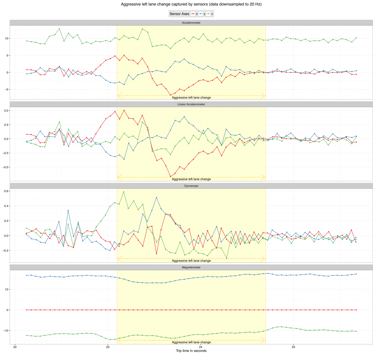
Figura 1 – Dados de sensores: acelerômetros, giroscópio e magnetômetro plotados no tempo (Ferreira et al. , 2017).
