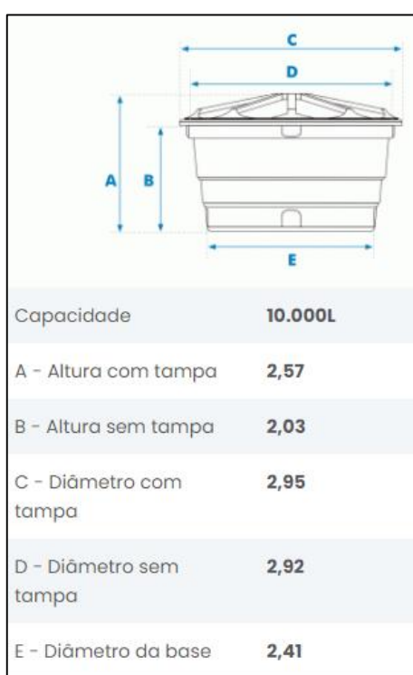
Figura 109 – Dimensões do reservatório adotado. (Fonte: Fortlev, 2021)
