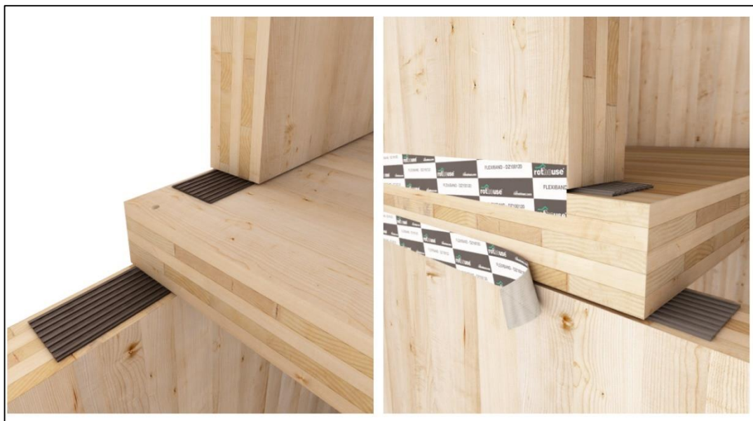
Figura 32 – Isolamento acústico no apoio dos painéis de laje e parede. (Fonte: Processing guideline binderholz CLT BBS, 2018)
