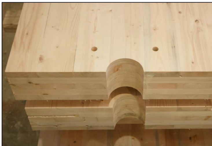
Figura 13 – Pré-furação das lajes. (Fonte: naturally:wood, 2017)
