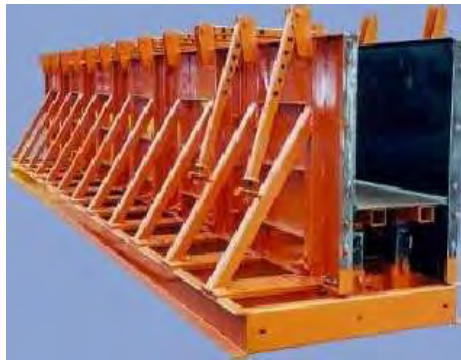
Figura 3.16 – Molde metálico para fôrma de viga.
