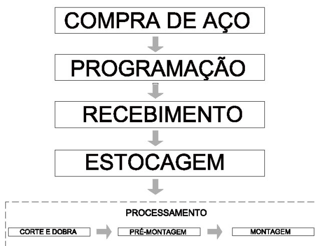
Figura 3.36 – Fluxograma de produção das armaduras para o aço entregue em barras. Adaptado de FACHINI (2005).
