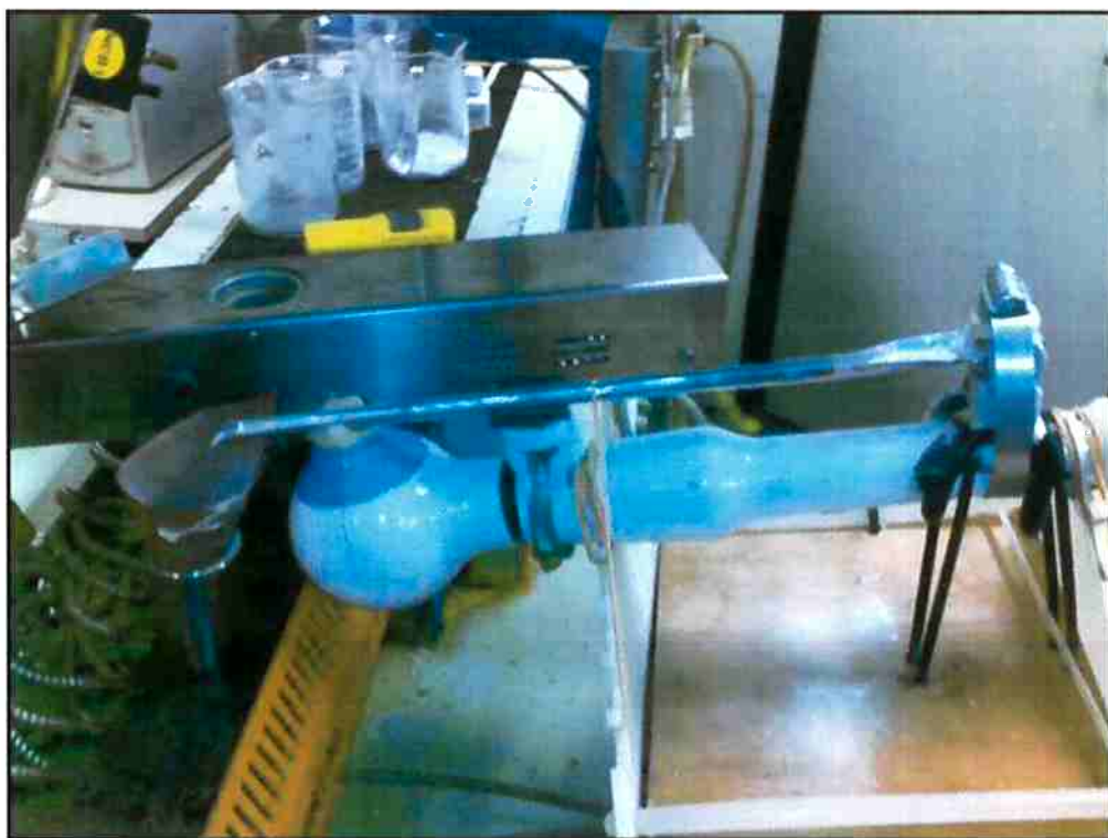
Figura 30- Aparato desenvolvido para adição de cargas na extrusora. A alimentação ocorre na segunda zona de alimentação da extrusora.
