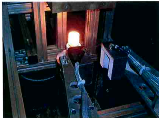
Figura 12 Garras do robô feitas de cerâmica isolante. Acima pela mangueira gás argônio é fornecido
