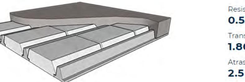
Modelo de laje pré-moldada em EPS (PROJETEEE)
