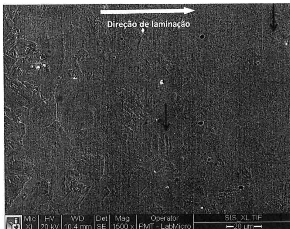
Figura 38 Mev com uma transição da amostra na parte do centro com 7.70% de níquel, e na parte sem precipitação de alto teor de níquel (10.24% níquel).
