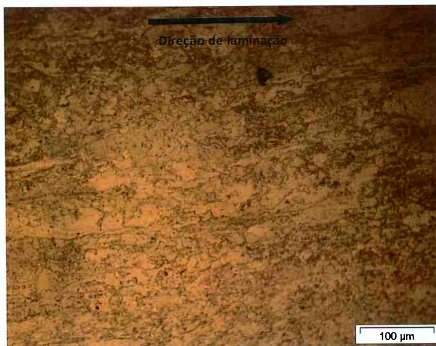
Figura 26 Microestrutura de baixo Ni e Recristalização feita a 550°C e 120 minutos com regiões de primeiros grãos feitos pela recristalização (vista de topo); ataque nital 2%.
