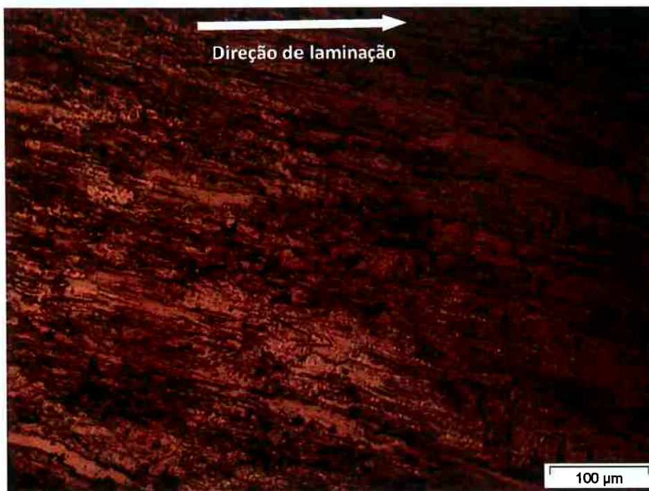
Figura 41 Tratamento de recristalização de 30 minutos a 550°C (vista de topo); ataque nital 6%
