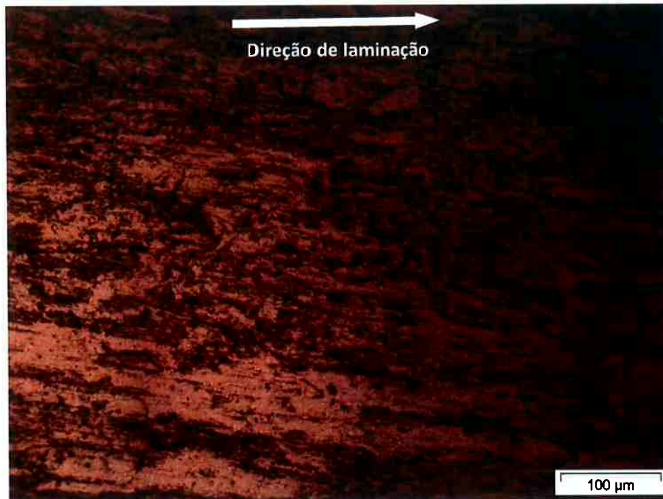
Figura 42 Tratamento de recristalização de 60 minutos a 550°C (vista de topo); ataque nital 6%
