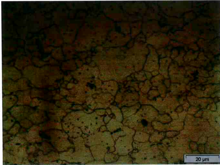
Figura 27 Microestrutura baixo Ni e Recristalização feita a 550°C e 240 minutos; ataque nital 6% com uma região de grãos de ferrita.
