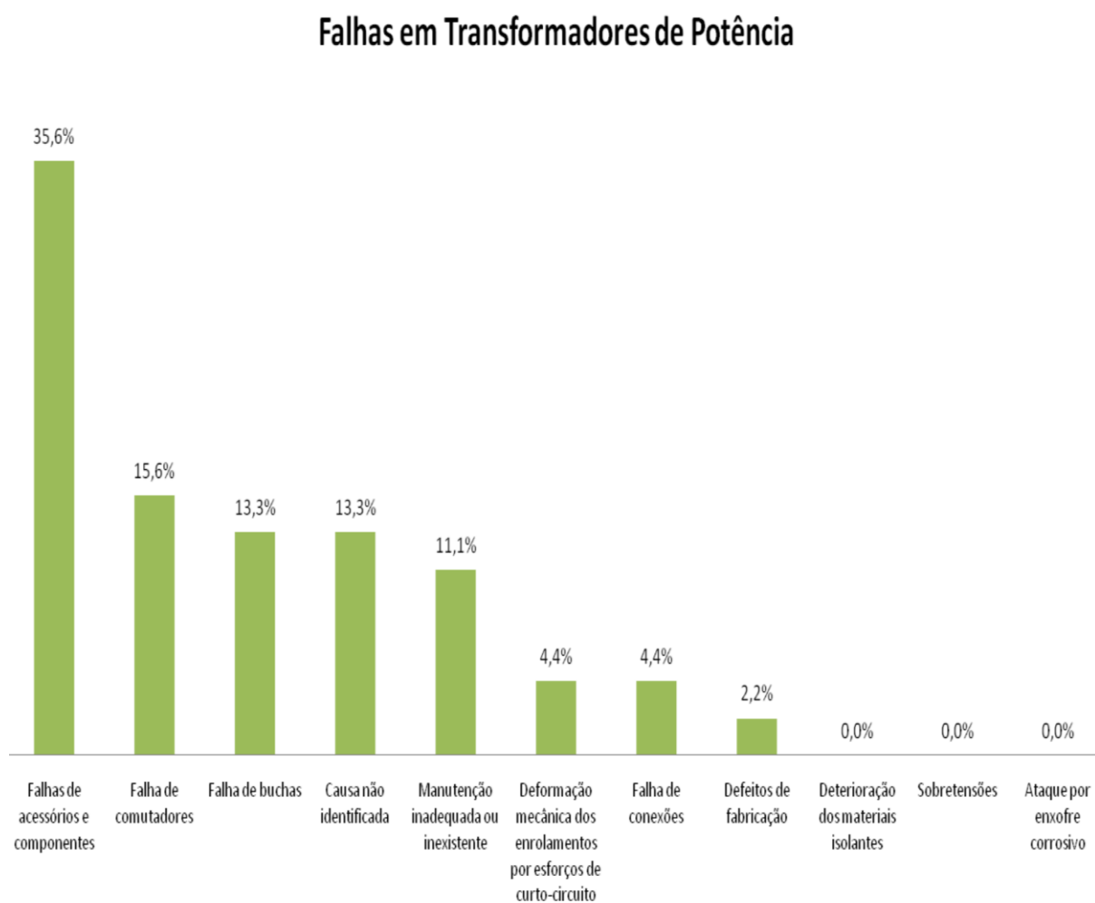
Figura 22 - Distribuição das principais falhas de transformadores de potência da Elektro [5]
