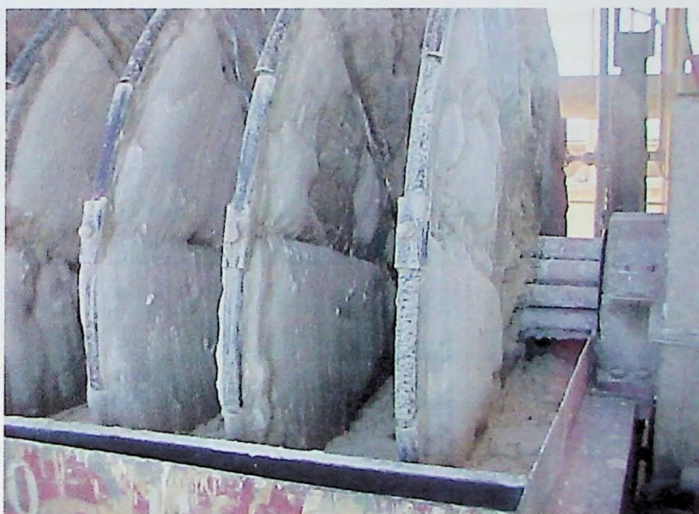
Foto 2 – Filtragem da polpa (concentrado + água) vinda do mineroduto
