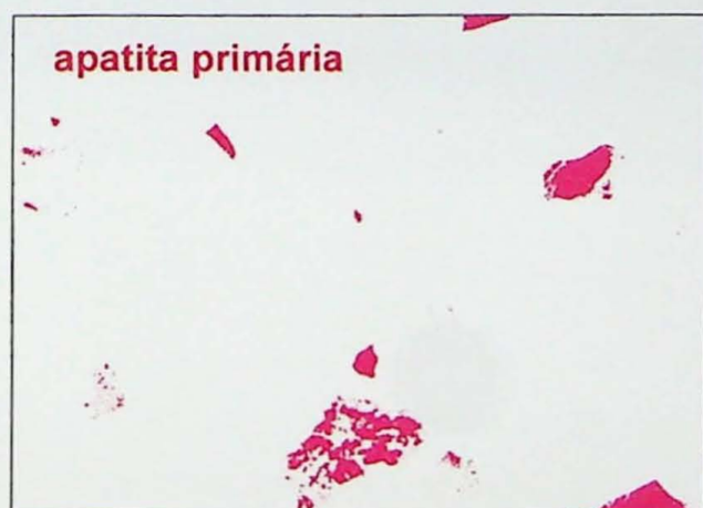
Foto 6 – Imagens binárias de apatita primária e secundária após processamento do par de imagens de BSE e CL (foto 5).
