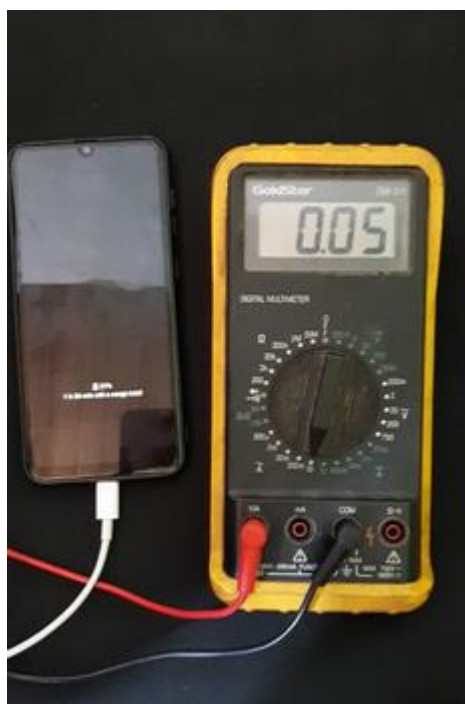
Figura 14 - Multímetro aferindo o carregador carregando um celular em descanso
