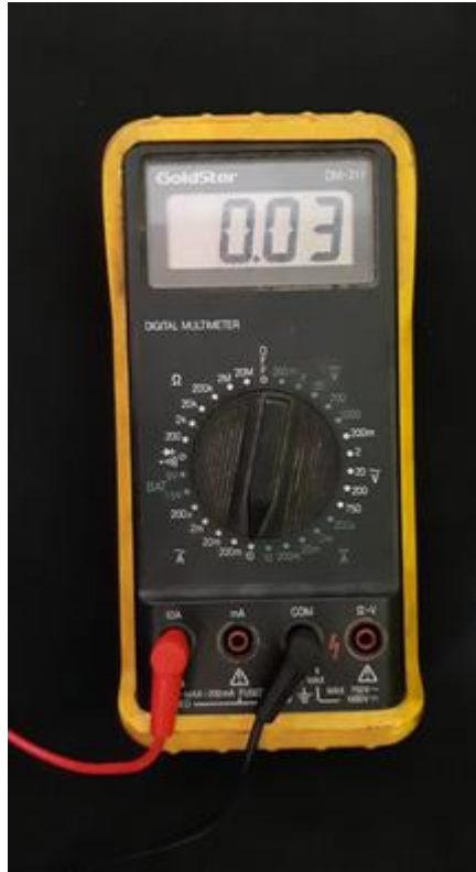
Figura 12 - Multímetro aferindo apenas o carregador ligado na tomada
