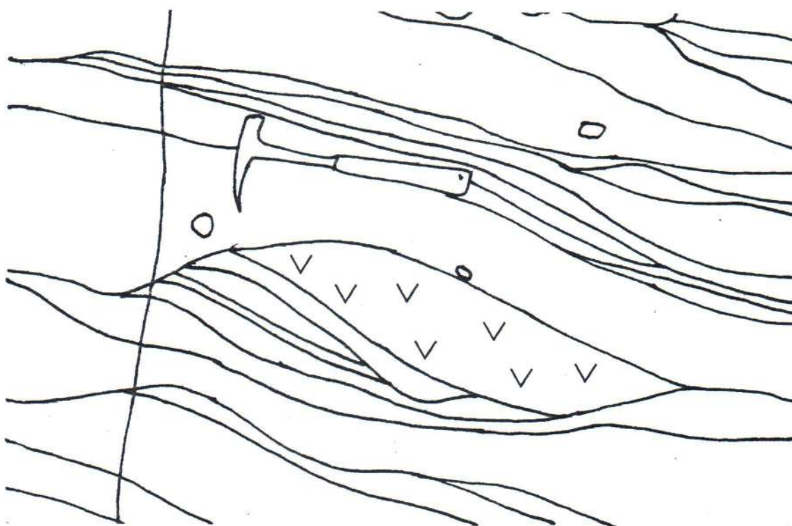
Figura 6.2.3.5 - Foto 2/V e desenho a partir de foto, Ponto TK 23 - Corpo anfibolítico assimetricamente deformado, sendo cortado por rocha granítica seguindo o traço S dos pares de foliação, sugerindo movimentação sinistral. Plano inclinado para Sudeste, com direção indicada.
