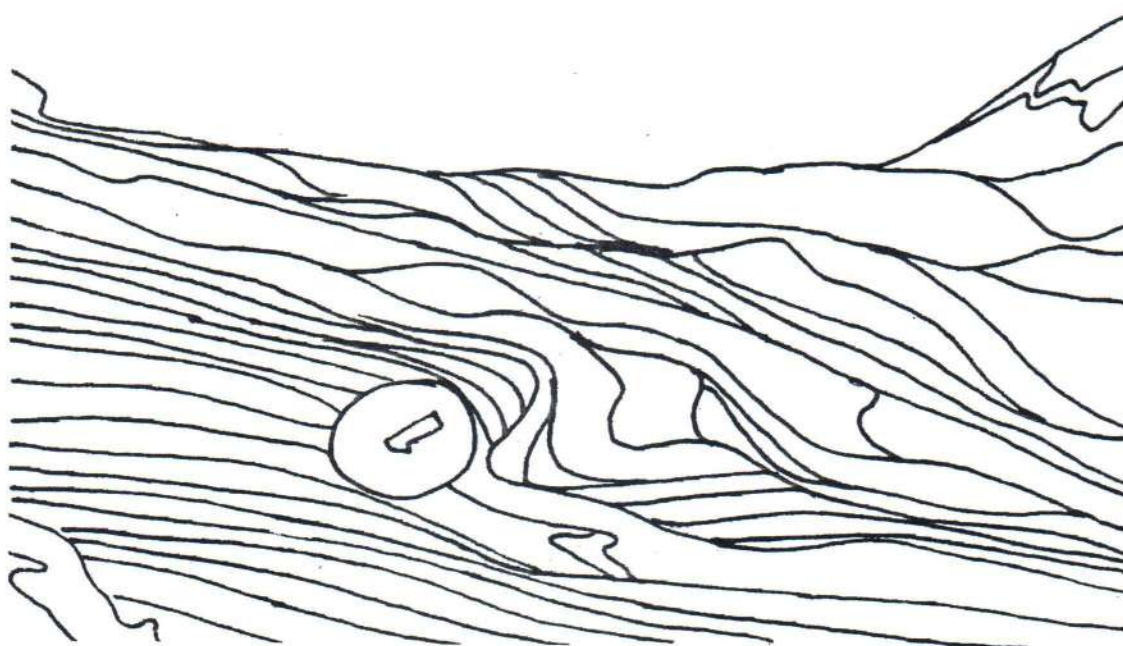
Figura 6.2.2.4 - Foto 11/II e desenho a partir de foto, Ponto TK 15. Dobras assimétricas em "Z" afetando material granítico que é envolvido por biotita gnaiss. Na porção central da estrutura, estão presentes lentes ricas em minerais micáceos que acompanham a geometria da estrutura, sugestivas de movimento dextral. Plano inclinado para sudeste com direção e sentido do movimento indicado.
