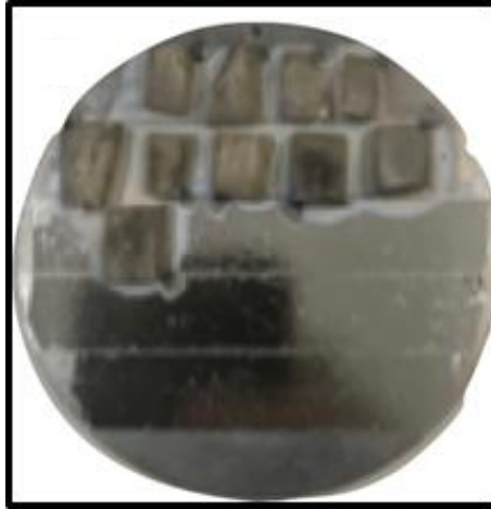
Figura 5 - Espécimes preparados para análise em Microscopia Eletrônica de Varredura.
