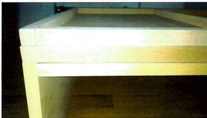
Figura 11 – Detalhe da parte superior, formada por MDF de 15 mm e 18 mm de espessura.
