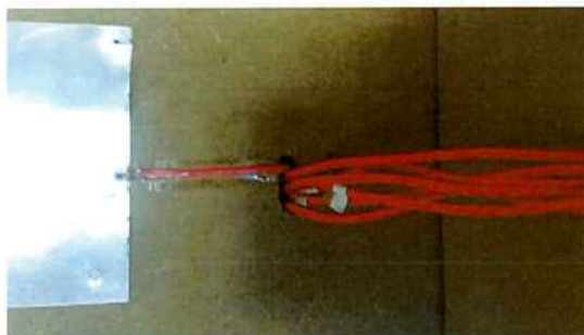
Figura 19 – Detalhe da furação feita na estrutura para proteger os fios que saem de dentro dos Pads.
