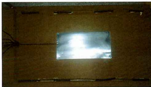
Figura 18 – Detalhe das borrachas laterais. Foram utilizadas apenas nas laterais mais compridas do Pad de modo que o contato não ficasse tão resistente à pressão.
