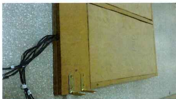
Figura 16 – Pad inferior encaixado, já com a fiação afixada e devidamente etiquetada.
