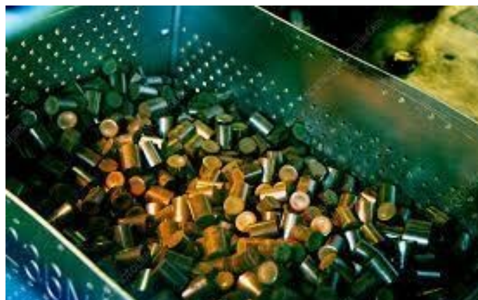
Figura 3.7: Resultado da fabricação de pastilhas - pellets de urânio [14]
