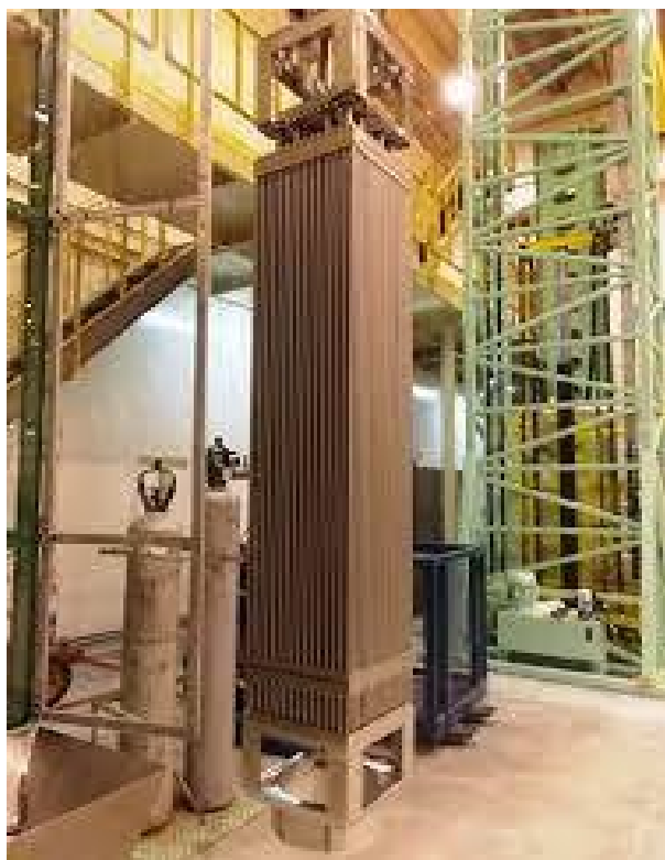
Figura 3.8: Estrutura com varetas que englobam os pellets de urânio [16]
