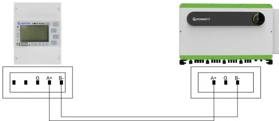
Figura 22 – Esquema de ligação entre o smart meter e o inversor.
