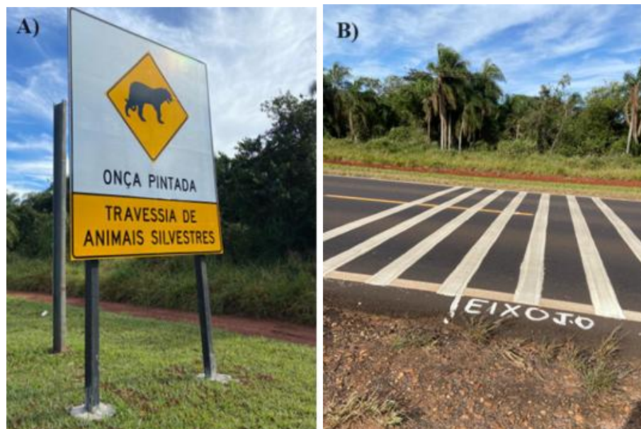
Figura 2: A) Placa de sinalização. B) Ondulação transversal e linhas de estímulo à redução de velocidade na rodovia SP-613, Teodoro Sampaio, SP.
