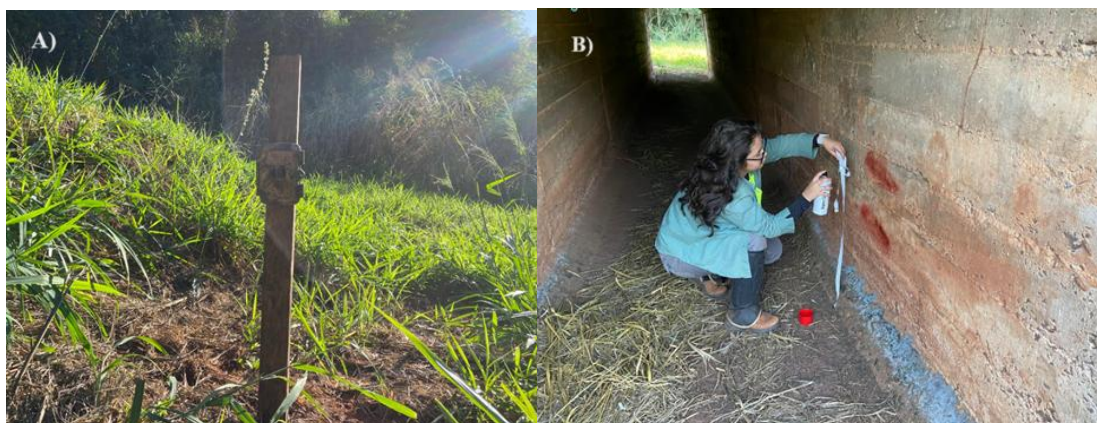
Figura 4: A) Instalação das câmeras com estaca de madeira na PIF. B) Marcação com tinta spray para observação do nível de água das PIFs na rodovia SP-613, Teodoro Sampaio, SP.
