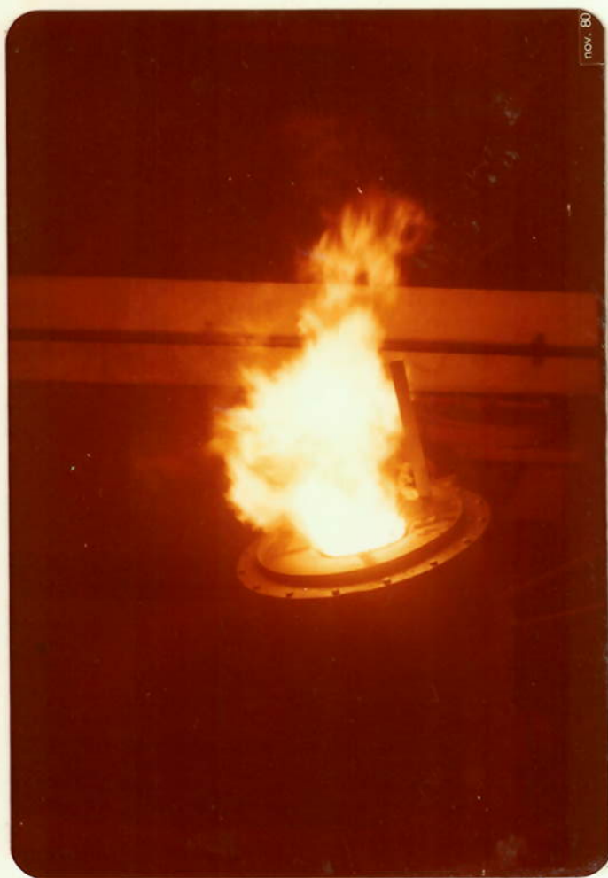
Fig. 30 - Queima de carvão vegetal com carga máxima.
