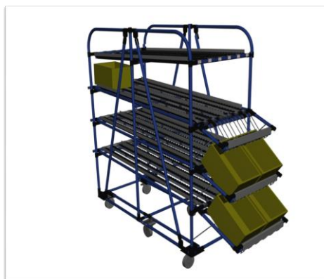
Figura 17 - Esquema de flow rack de gavetas pequenas.
