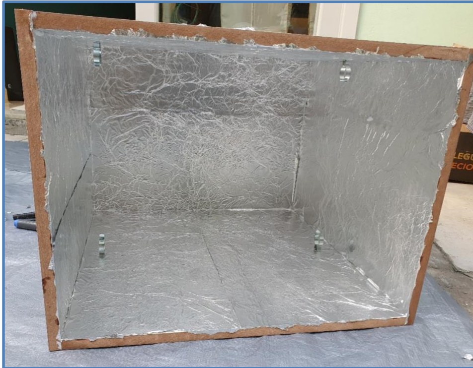
Imagem 17 – Montagem das paredes e fixadores das lâmpadas
