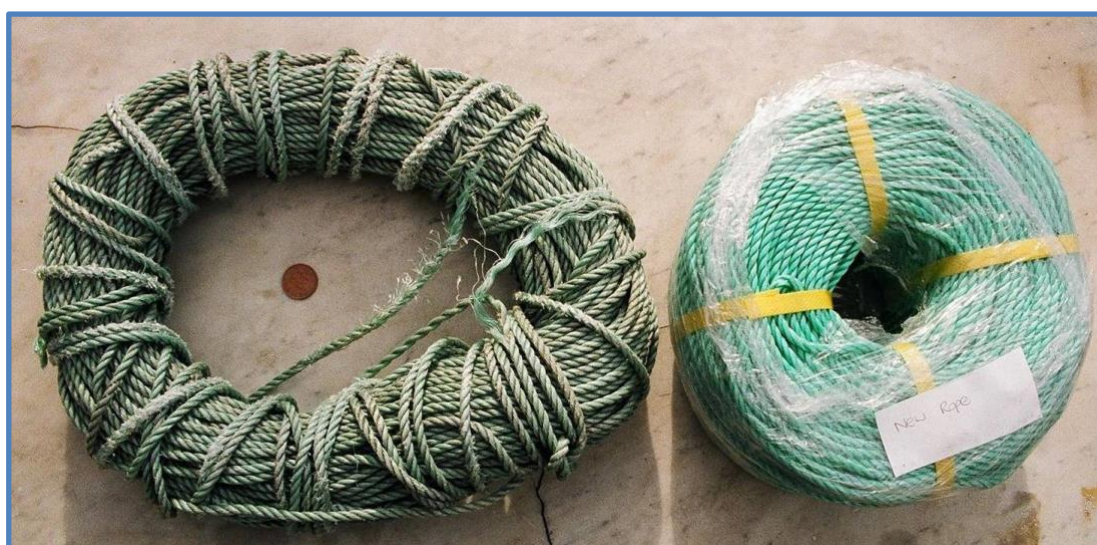
Figura 2 – Degradação de corda de polipropileno
