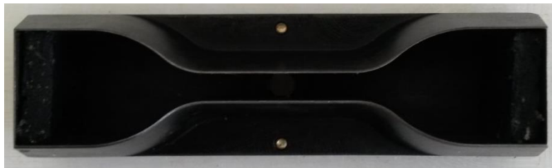
Figura 7 – Molde para corte do corpo de prova
