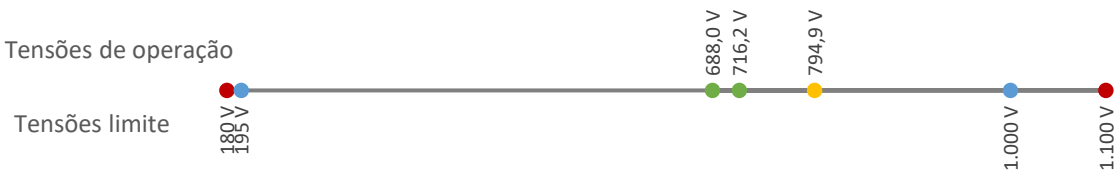
Figura 3.22 – Resumo da checagem das tensões limites operacionais do inversor
