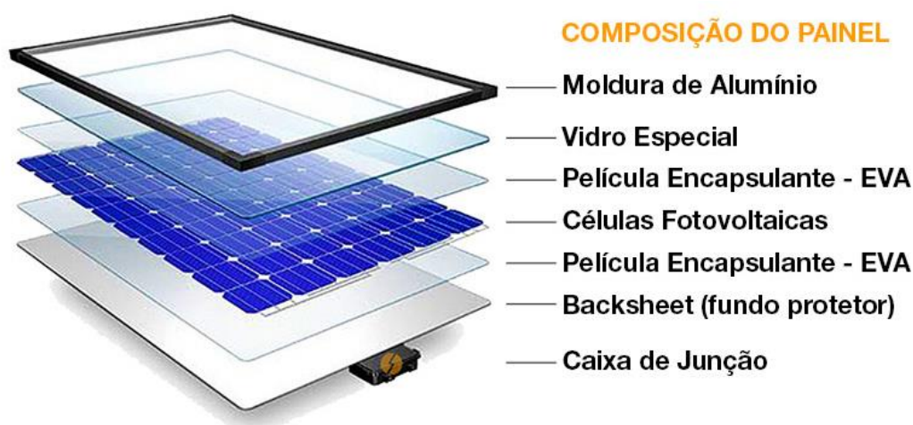
Figura 2.4 – Composição construtiva simplificada de um Painel Fotovoltaico
