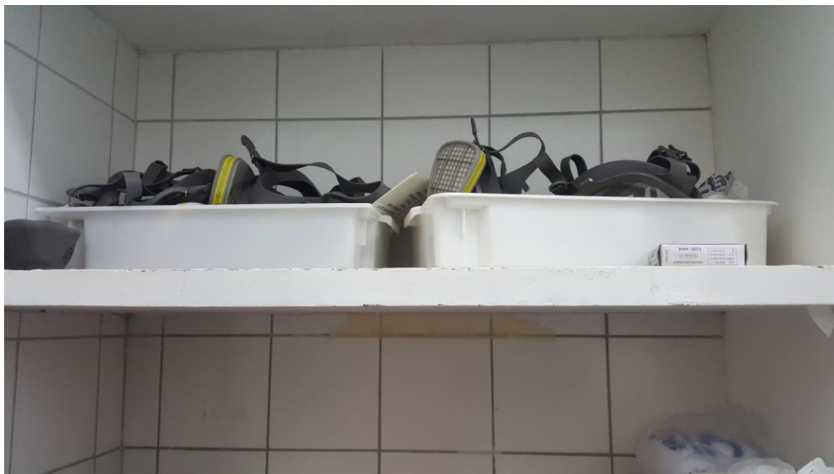
Figura 3 - Armazenamento de EPR sem proteção contra riscos físicos, químicos e contaminação
