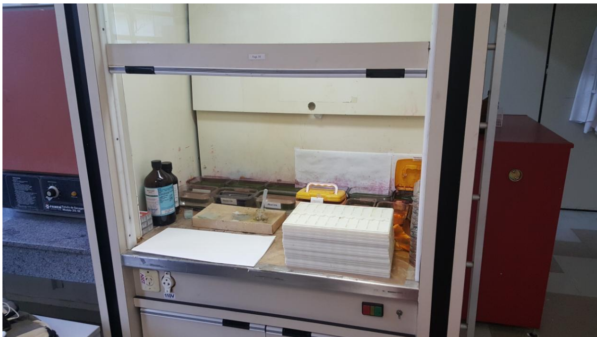
Figura 8 - Capela de exaustão de agentes químicos para coloração manual de lâminas de exame Papanicolau
