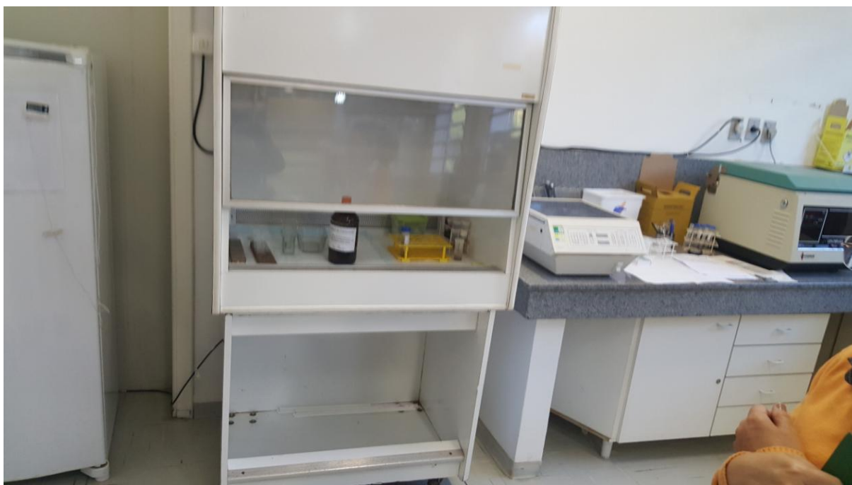
Figura 9 - Cabine de segurança biológica classe 2 de fluxo laminar para processamento das amostras biológicas
