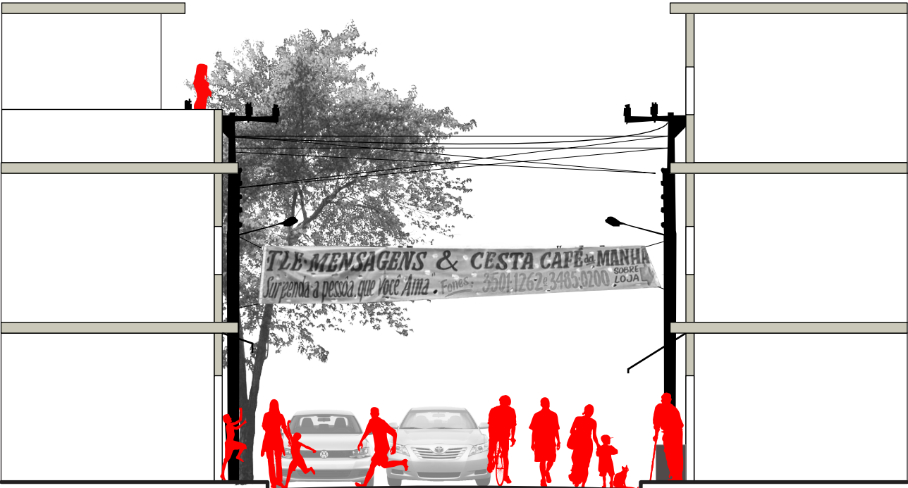
Imagem 15: Corte genérico da tipologia Rua. Escala 1:100. As ruas têm uma largura média de 7m. Fonte: Elaborado pela Autora
