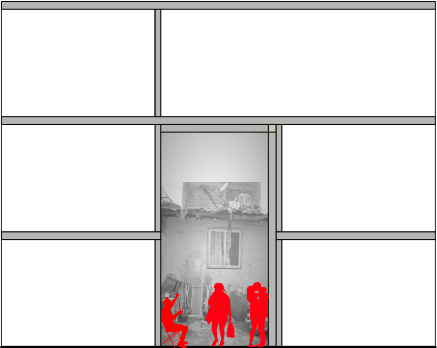
Imagem 16: Corte genérico da tipologia Viela como Passagem. Escala 1:100. As vielas têm uma largura média de 2-3 m. Fonte: Elaborado pela Autora
