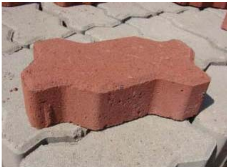
Figura 12.7 – Bloco de concreto pré-moldado de 16 faces com coloração vermelha 43
