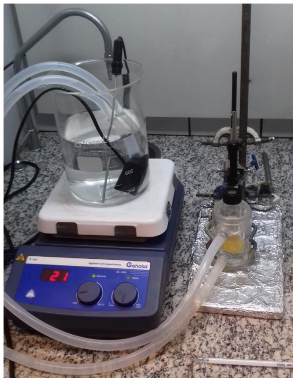
Figura 1. Sistema para extração de voláteis do suco integral de tangerina por SPME utilizando béquer encamisado com circulação de água. Fonte: autoria própria.
