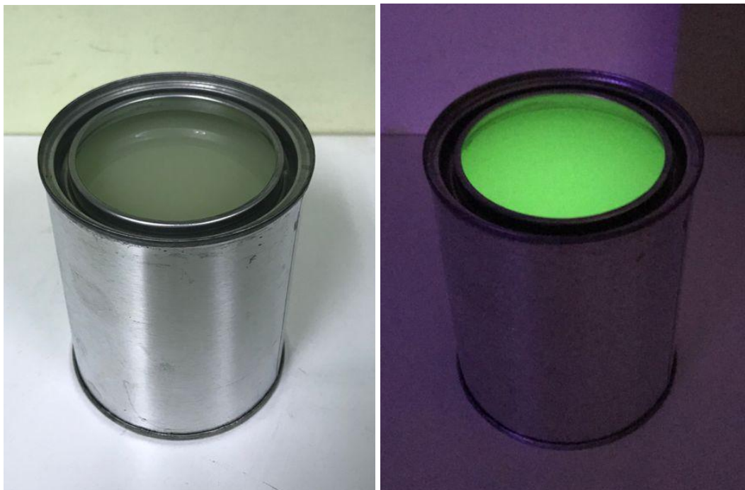
Figura 6 - Composição do diluente e pigmento: com luz (esq.) e sem luz (dir.)
