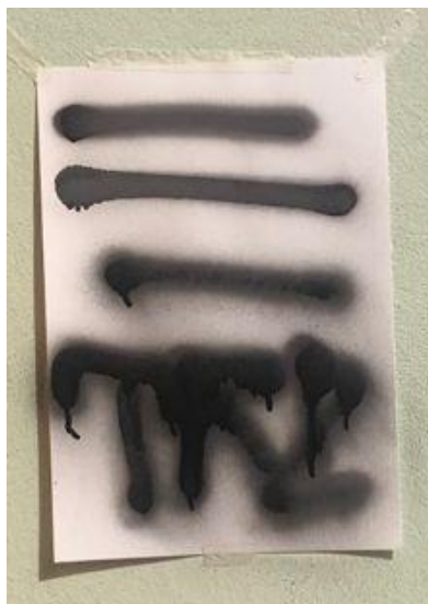
Figura 9 - Teste dos caps slim e fat sobre o papel duplex, com o spray da ColorGin
